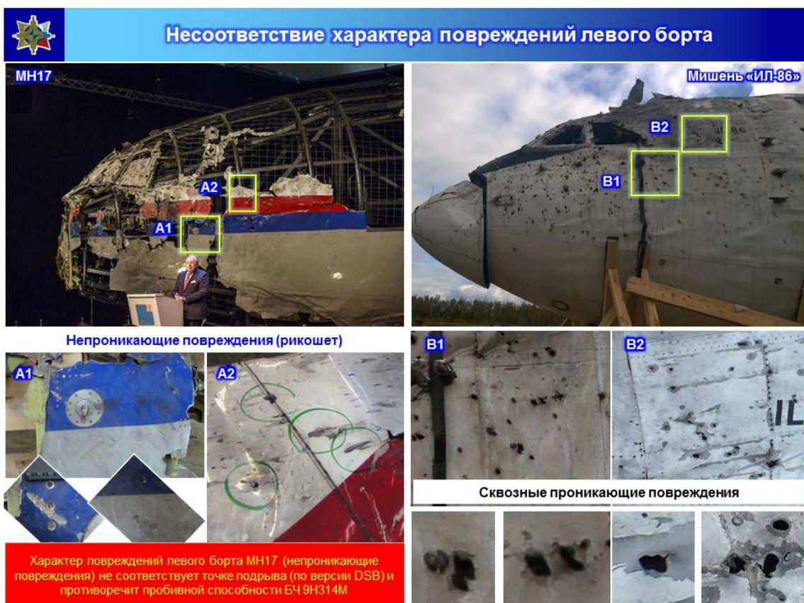
*Сравнение характера и плотности осколочных повреждений*
